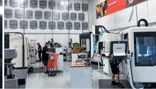
Andretti Autosport, w obszarze obróbki stawia na technikę toczenia i frezowania DMG MORI: [od lewej do prawej] NLX 2500 SY I 700, CMX 1100 V, DMU 50.
