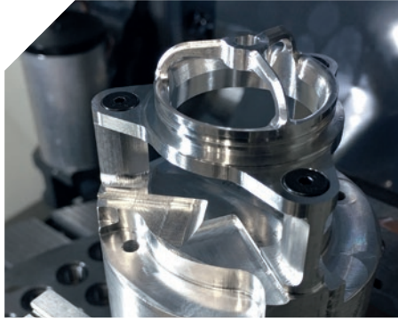
Przykład: wysoko precyzyjny zawór do samochodu wyścigowego Andretti Autosport, obrabiony na 5-osiowej uniwersalnej frezarkcie DMU 50 marki DMG MORI.
